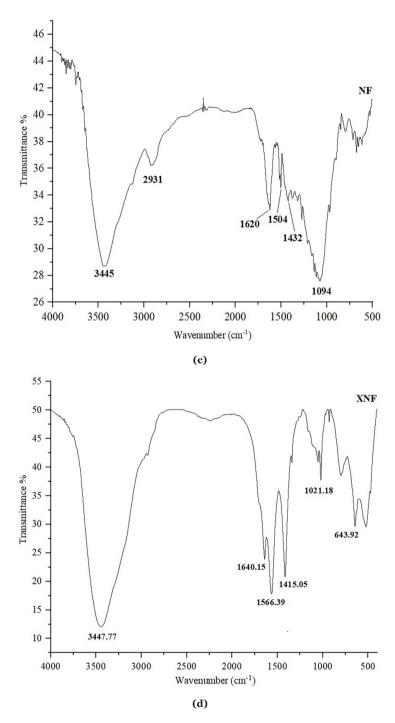
Figure 4. FT-IR spectrum of (a) Fluconazole, (b) XF, (c) NF, and (d) XNF
